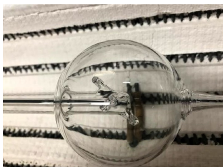
图2 射流搅拌器实图
